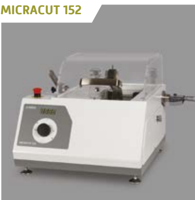
Hassas Kesme Cihazı Maks. Disk Boyutu 175 mm, Hız Sınırı 50-1500 rpm.
